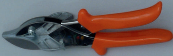
Profil-Schere zum problemlosen Schneiden von Kunststoffplatten und -profilen, max. Schneidestärke ca. 4mm Bestell-Nr. 8187/20
