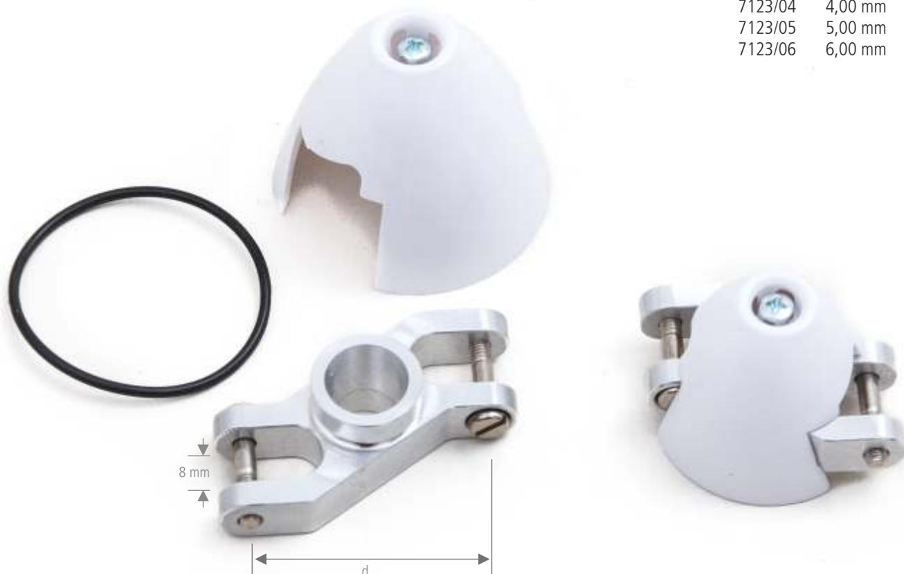
\* Die Angaben von Propellergrößen beziehen sich immer auf einen Achsabstand  $d=42$  mm. Bei Verwendung der Z-Mittelstücke verringert sich der Achsabstand und damit auch der  $\emptyset$  des Propellerkreises. Bsp.: 12" Propeller mit 30mm Z-Spinner = Propeller- $\emptyset$  11,3"
