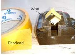
Die Bügel 219 und 221 auf einer Balsaleiste o.ä. mit den Biegenuten nach oben mit Klebestreifen fixieren.
