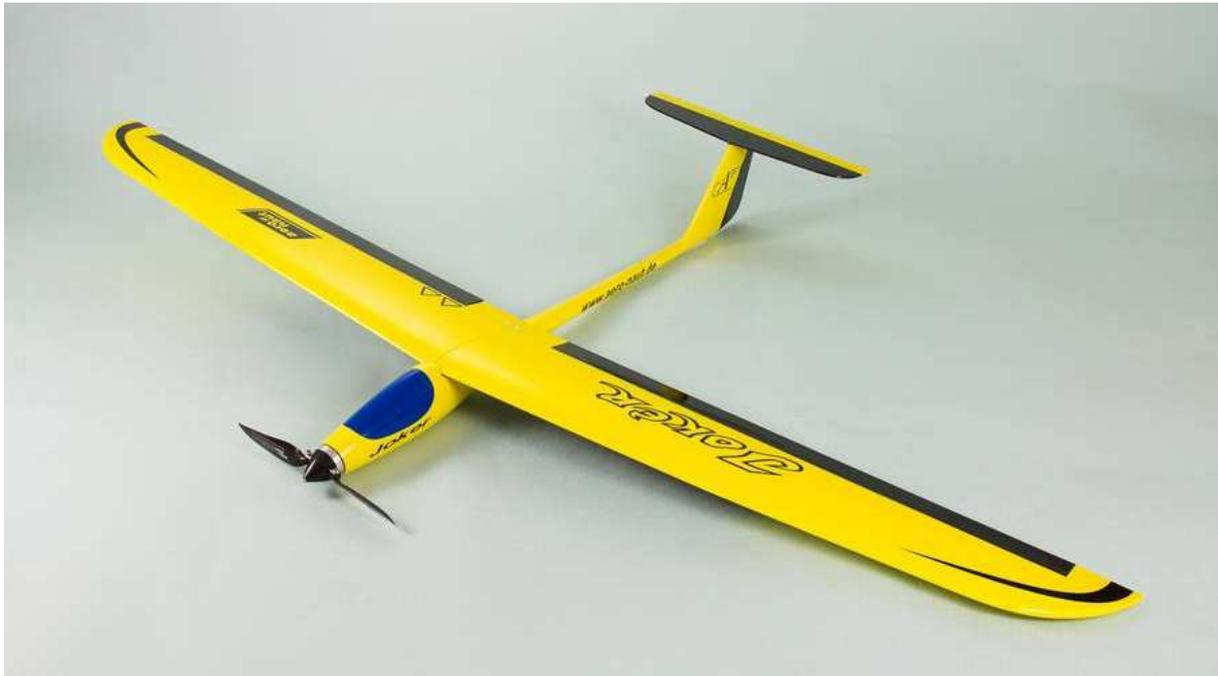
Der „Joker“ ist ein schnelles und wendiges Hochleistungs-Segelflugmodell. Es kann mit und ohne Elektromotor gebaut werden. Die Tragfläche besteht aus zwei Teilen, wurde aus Styropor gefertigt und mit Furnier beplankt. Der Rumpf wurde aus GFK hergestellt und ist zum Einbau der RC-Anlage vorbereitet. Aufgrund der kleinen Transportgröße ist „Joker“ ein idealer Begleiter auch auf Bergtouren oder Wanderungen.
